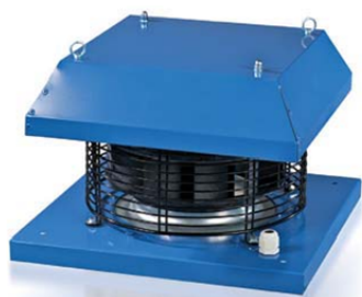
Centrifugalni krovni ventilatori sa kapacitetom protoka vazduha do 4700 m 3 /h u čeličnom kućištu sa vertikalnim izduvavanjem vazduha. Namijenjeni su za sisteme izduvne ventilacije.
