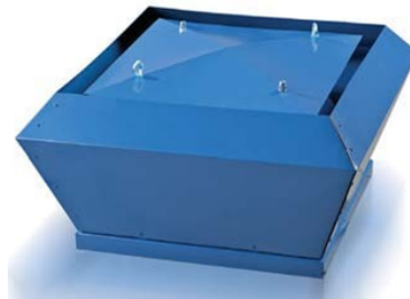
Centrifugalni krovni ventilatori sa kapacitetom protoka vazduha do 4700 m 3 /h u čeličnom kućištu sa horizontalnim odvodom vazduha. Namijenjeni su za sisteme izduvne ventilacije.
